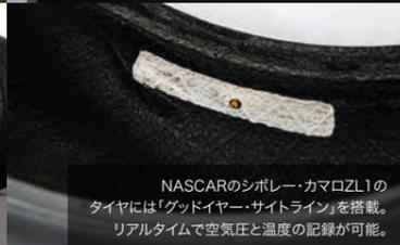
NASCARのシボレー・カマロZL1のタイヤには「グッドイヤー・サイトライン」を搭載。リアルタイムで空気圧と温度の記録が可能。
