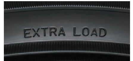
タイヤの幅、扁平率、インチ数が同じでも、最大荷重を表すロードインデックス(LI)はXL規格の方が高くなります。
