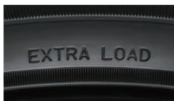
タイヤの幅、扁平率、インチ数が同じでも、最大荷重を表すロードインデックス(LI)はXL規格の方が高くなります。
