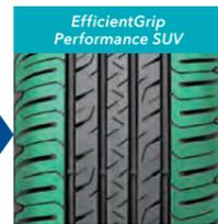
ショルダーブロックを最適化することにより、路面への衝撃を緩和し、ピッチノイズを低減。さらにショルダーグループのデザインがタイヤ回転時の気柱共鳴音の軽減に貢献しています。
