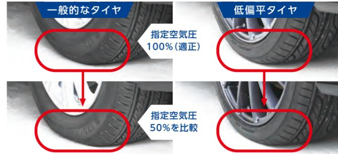
一般的にタイヤがたわめば空気圧の減少が分かりますが、低扁平タイヤは見た目の変化が少なくエアゲージによる点検が必要です。
