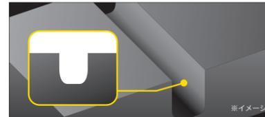
摩耗が進むと途中で溝幅が拡大します。装着初期のトレッドブロックの安定によるトラクション性能と、摩耗後のウェット性能を両立しています。
