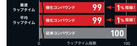
テスト条件 ●テスト車両: 国産2.0セダン 4WD ●タイヤサイズ: 245/40R18 93W ●空気圧: フロント [230kPa] / リア [190kPa] ●テスト場所: 岡山国際サーキットレーシングコース ●ドライバー: 生産委託先テストドライバー ※詳細なデータは、タイヤ公正取引協議会に届け出てあります。
