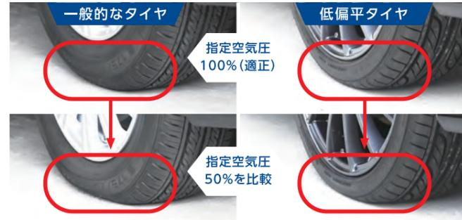
一般的にタイヤがたわめば空気圧の減少が分かりますが、低扁平タイヤは見た目の変化が少なくエアゲージによる点検が必要です。
