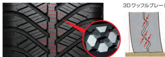
センターエリアのサイブ側面にワッフル状の凹凸を形成。ブロック間が支えあい、高い剛性を生み出すことで、路面を選ばず優れた運動性能を実現。偏摩耗の抑制にも貢献します。
